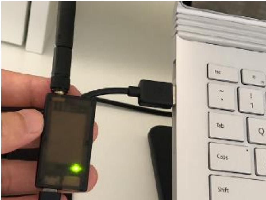
Рис. 3.4. Підключений модуль телеметрії робочої станції
