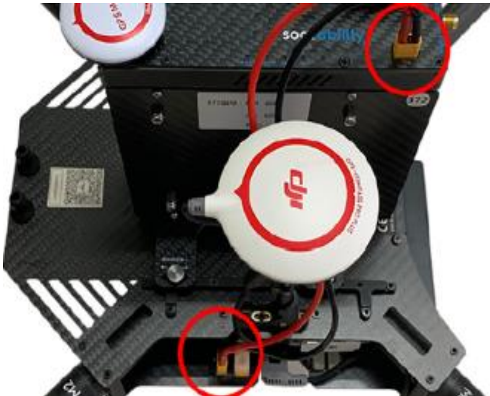
Рис. 3.3. Підключений блок Sniffer4D до джерела живлення квадрокоптера
