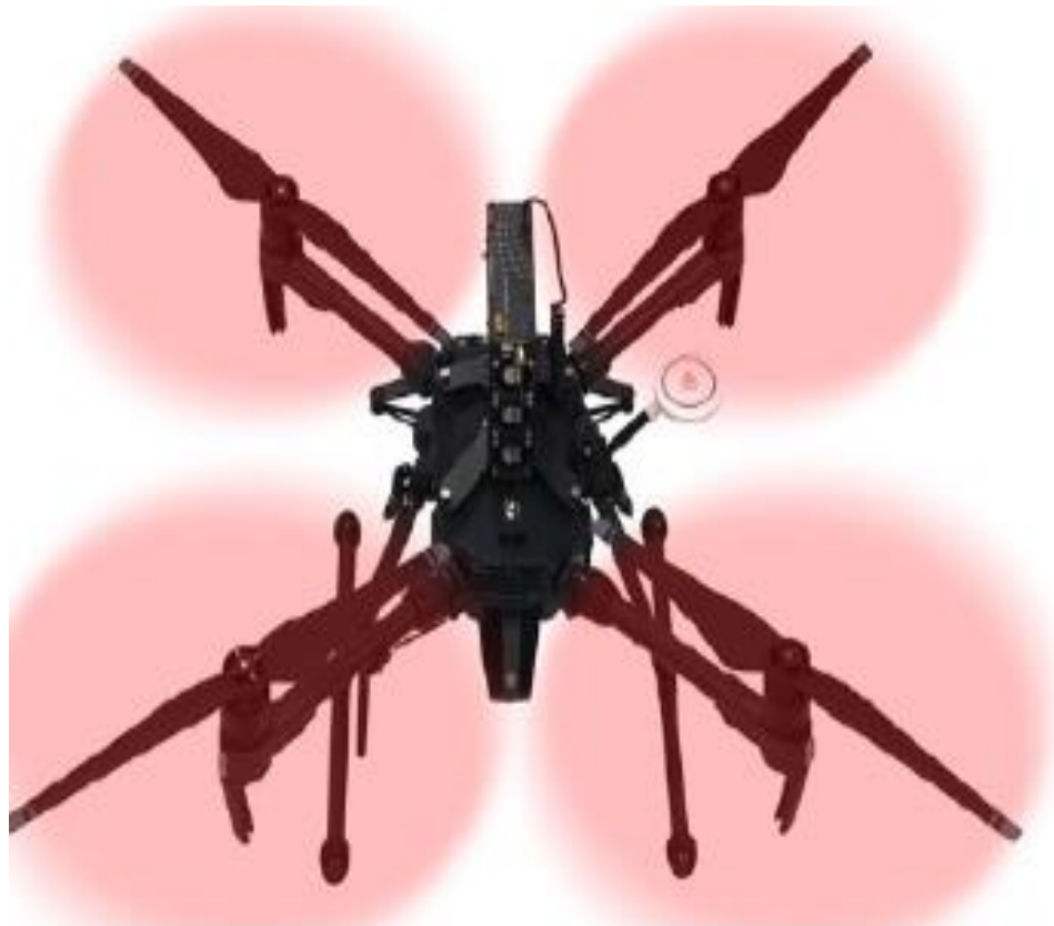
Рис. 3.2. Інтеграція блоку Sniffer4D з квадрокоптером DJI M100
